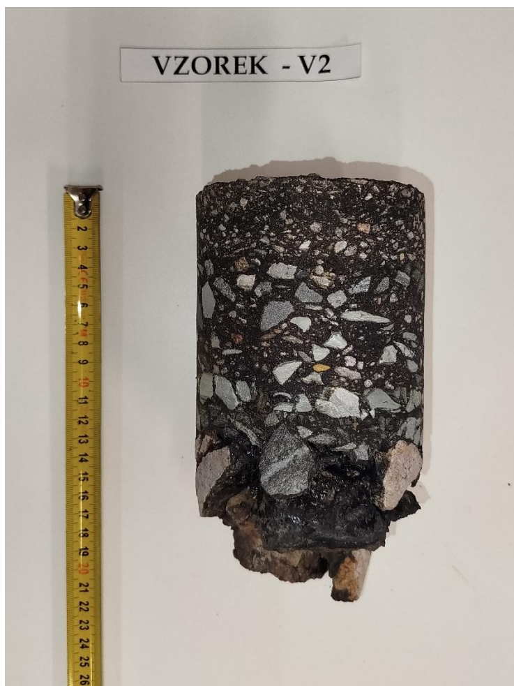
Obr. 4 - Jádru vývrtu Vzorek – V2 (laboratoř).
