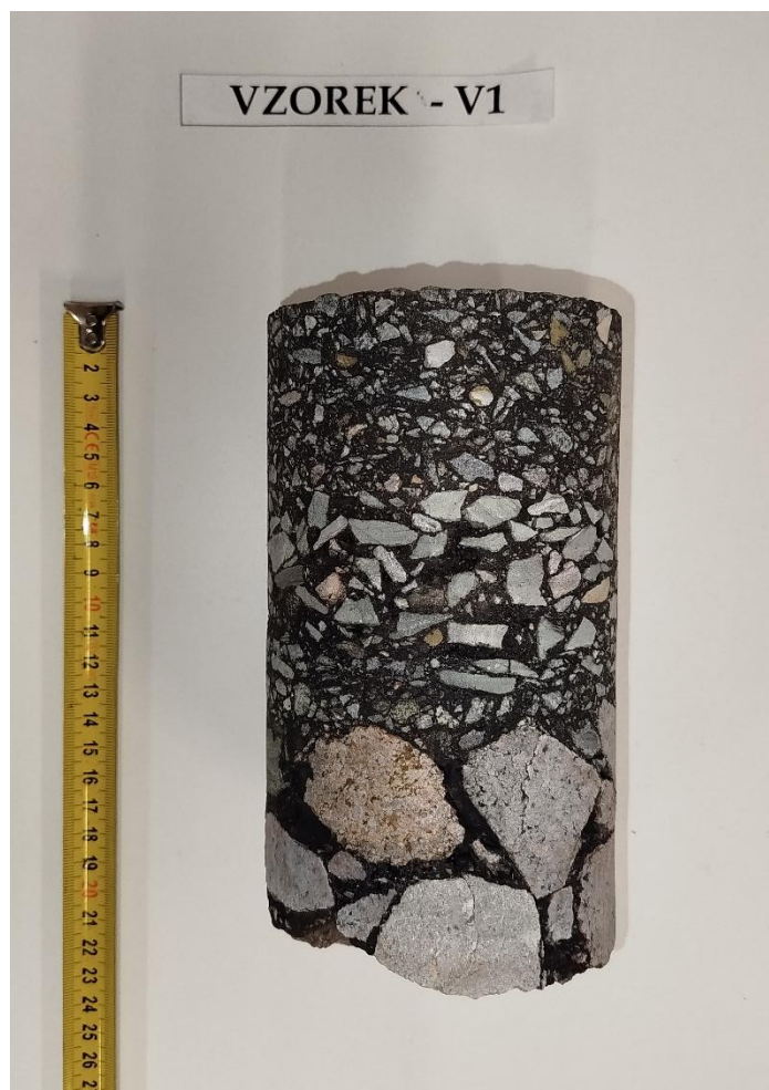
Obr. 2 - Jádru vývrtu Vzorek – V1 (laboratoř).
