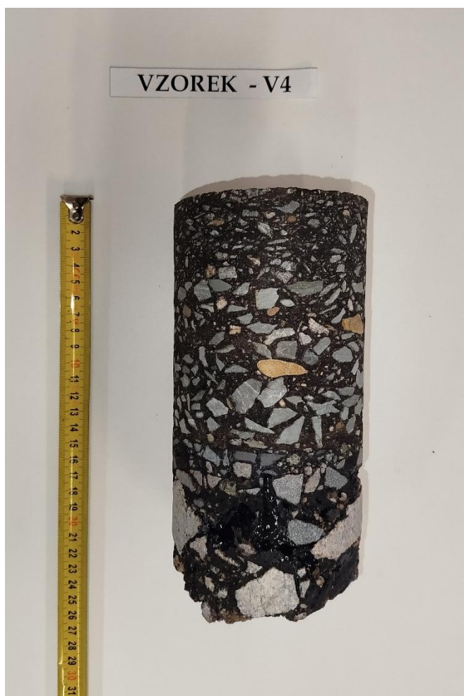
Obr. 8 - Jádru vývrtu Vzorek – V4 (laboratoř).
